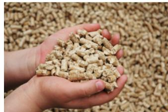
Holzpellets sind trocken, rieselfähig und haben einen Energieinhalt von etwa 4,8 kWh je Kilo; oder anders herum gesprochen: Rund 200 g entsprechen 1 kWh. [Foto: Deutsches Pelletinstitut]
