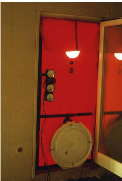
Und so wird die Luftdichtheit geprüft: Ein in die Haustür eingeklemmter Ventilator erzeugt einen Differenzdruck von 50 Pascal. Der dabei ermittelte Luftstrom ist das Maß für die Dichtheit.
