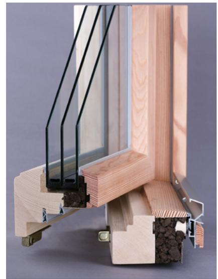
Schnitt durch ein gedämmtes Fensterprofil für eine Dreifachverglasung aus Holz. Der U-Wert des Rahmens liegt bei  $0,73 \text{ W}/(\text{m}^2\text{K})$ , der der Verglasung bei  $0,7 \text{ W}/(\text{m}^2\text{K})$ .
